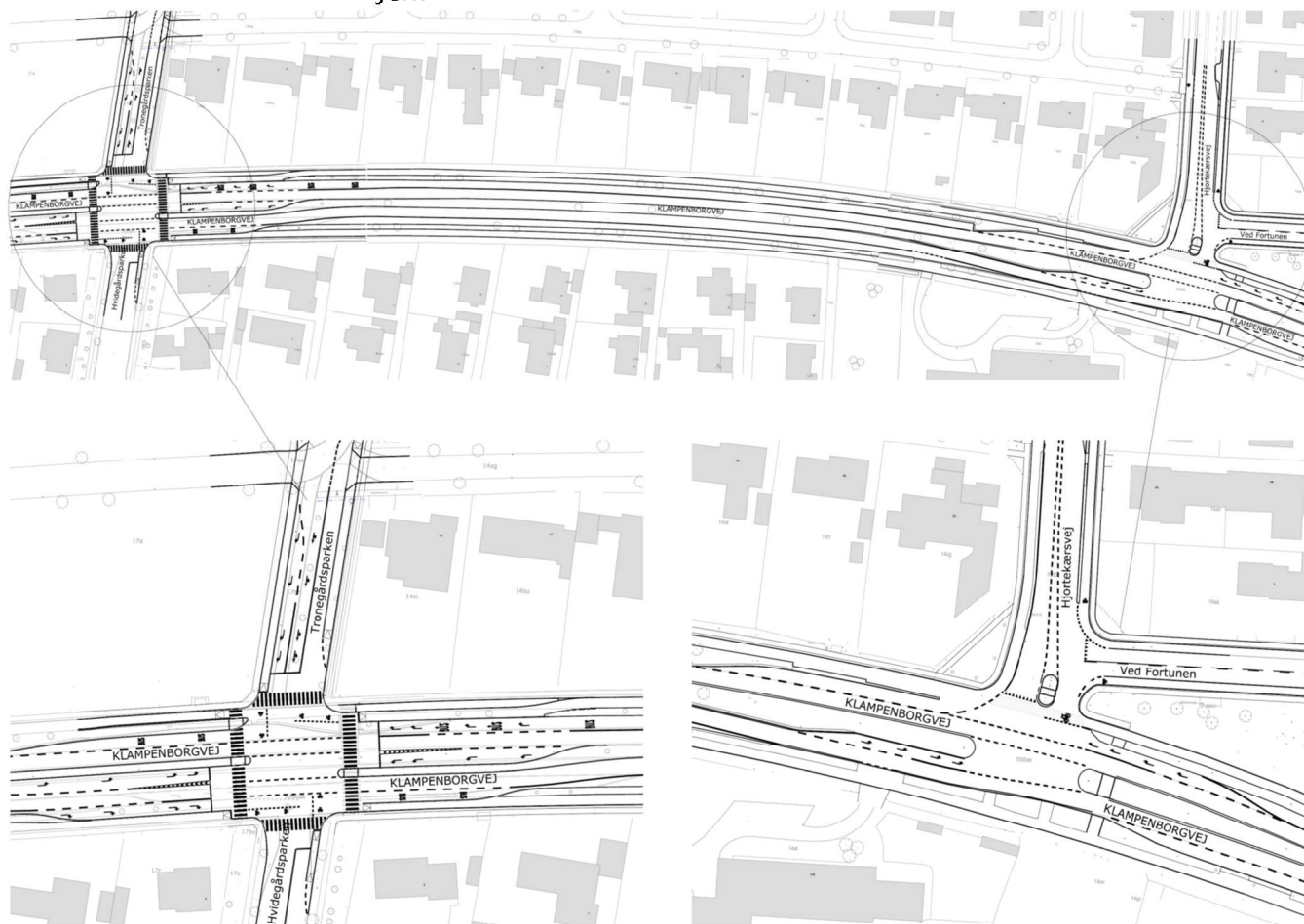
Figur 2: Simuleret udformning af Klampenborgvej i 2024 og 2032. Krydsets nordlige ben er en principiel udformning, der skal detaljeres senere. Figuren illustrerer at der er forbindelse fra Klampenborgvej til både det nye område og den eksisterende vej - Trongårdsparken.
